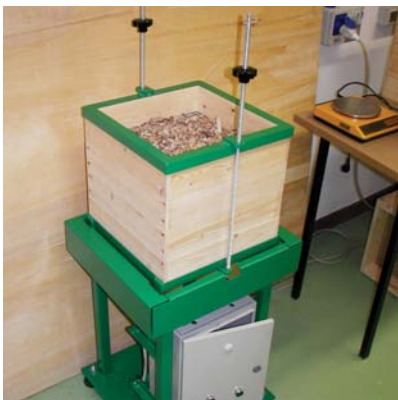
Vaglio per la determinazione delle classi dimensionali del cippato (AIEL, 2006).
